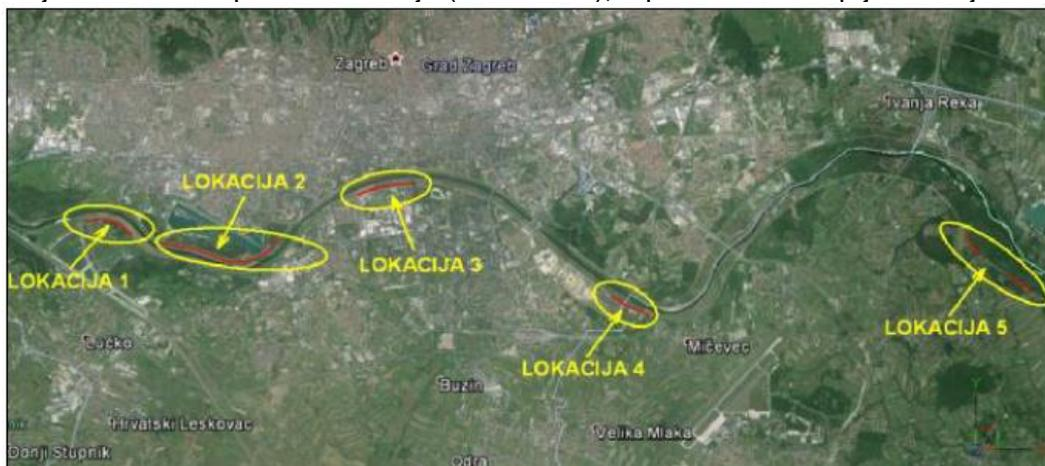
Slika 3.2.1: Prikaz pretpostavljenih najkritičnijih dionica savskih nasipa (preuzeto iz: Idejno rješenje rekonstrukcije lijevoobalnog savskog nasipa na potezu - Jadranski most – Jarun od st. 704+000 do st. 707+000, Geotehnički studio Zagreb, 2020)
