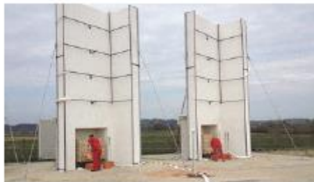
Paljenje konstrukcije od drvenih letvica – početak požara
