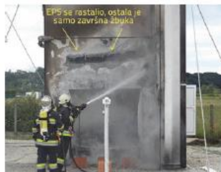
66 minuta nakon početka – vatrogasci polijevaju EM_2 zbog sigurnosnih razloga
