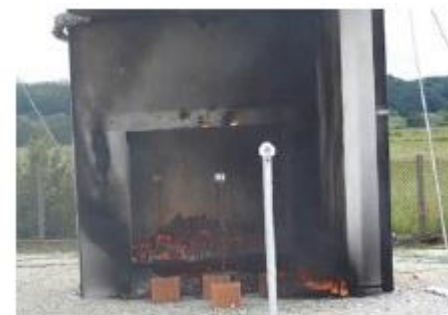
54 minute nakon početka – tinjanje uzorka EM_2
