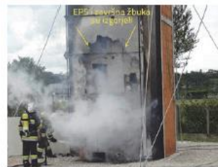
67 minuta od početka – vatrogasci polijevaju E_1 zbog sigurnosnih razloga
