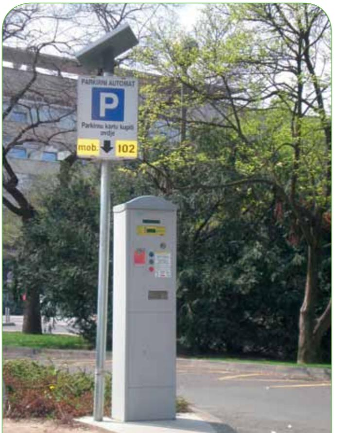
Slika 5.2. Automat za naplatu parkiranja na solarnu energiju
