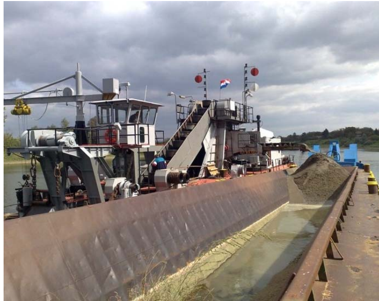
Slika 3.3.5.-1. Barža sa pokretnim dnom za prijevoz kamenog materijala
